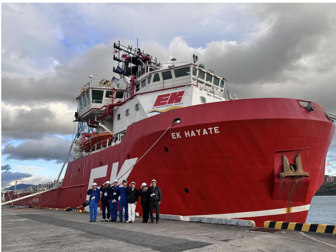
地質調査を通じて、海底の地下構造を明らかにすることで、洋上風力発電の実施可能な海域を判断し、施設の配置計画や設計を検討することができます。本船は、日本籍の地質調査船として、定点保持装置であるダイナミック・ポジショニング・システム（DPS）や動揺補正機能を
